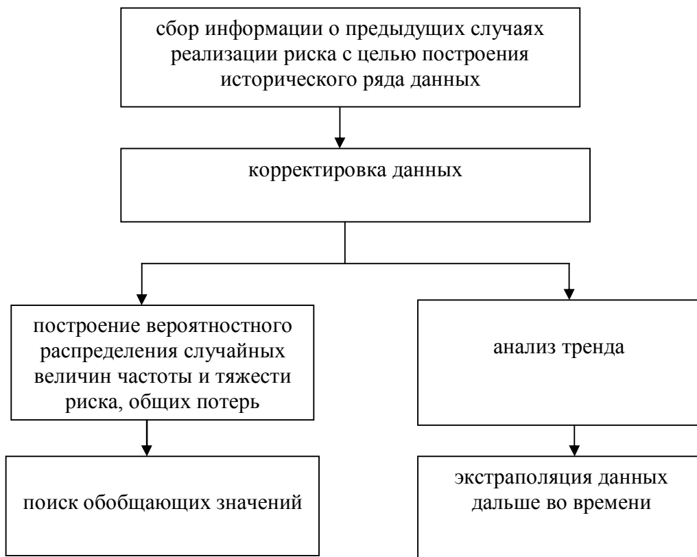
Рисунок 5.11. Логическая последовательность использования статистических методов
